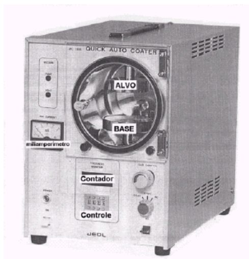
Figura 3.3: Vista equipamento utilizado para efetuar as metalizações. Quick Auto Coater da JEOL (JFC-1500).
