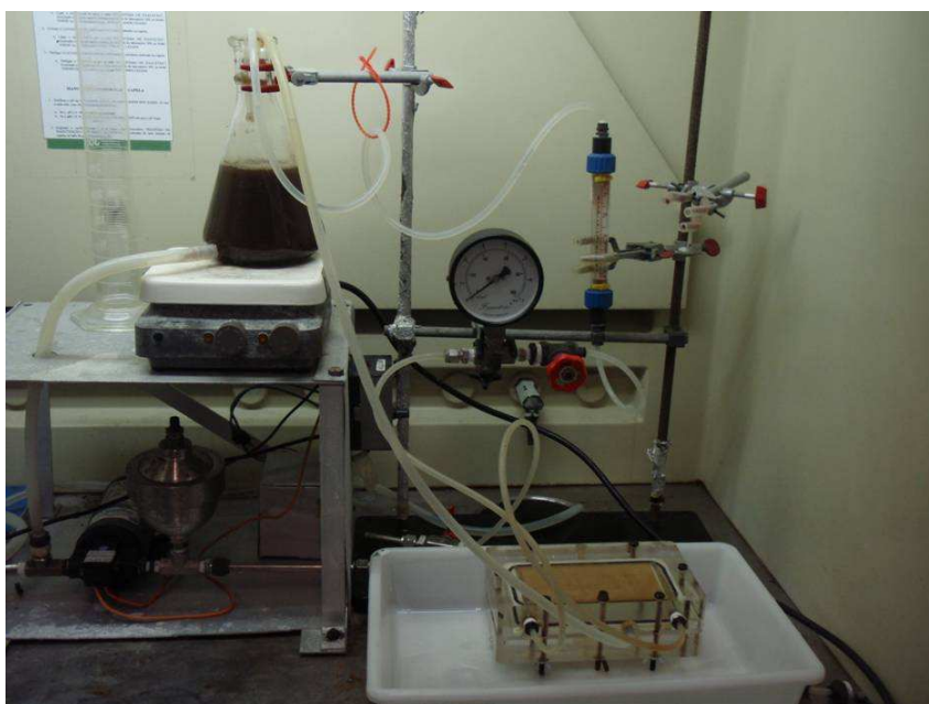
Figura 40: Foto do sistema de BRM de placas planas de bancada.
