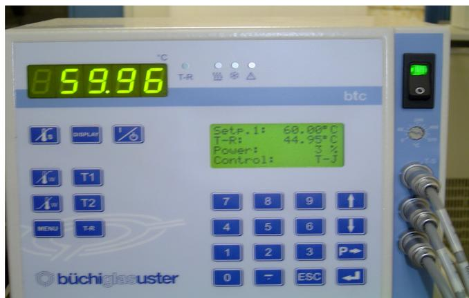
Figura 4.3.1.1. Indicação da temperatura do reator (T-R) e da camisa (T-J) no painel controle com o *set point* definido na camisa (T-J).
