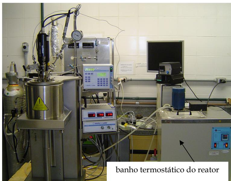
Figura 4.3.3.2. Aparato experimental para reação de transesterificação de óleo de soja com mistura etanol+CO<sub>2</sub>.
