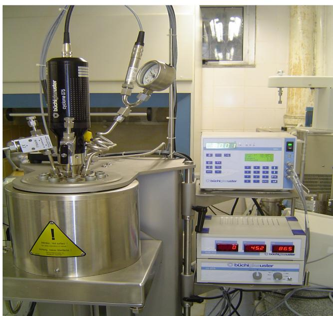
Figura 4.3.1.2. Indicação de temperatura e pressão do reator no painel de controle com o *set point* definido na camisa (T-J).
