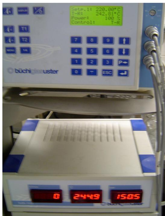
Figura 4.3.3.9. Reação de óleo de soja com etanol+CO<sub>2</sub> (razão molar etanol:óleo 25:1 e razão mássica CO<sub>2</sub>:etanol 0,22:1) em uma batelada de 30 minutos. Indicação de pressão e temperatura do reator no painel de controle com o *set point* definido na camisa (T-R).
