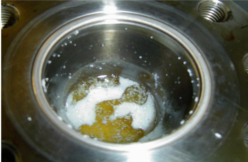
Figura 4.3.1.6. Reator aberto após reação enzimática de óleo de soja com etanol na presença de CO<sub>2</sub> supercrítico a 45°C e 79,3 bar.
