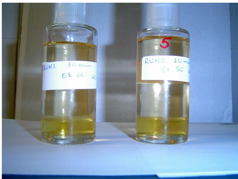
Figura 4.3.2.5. Amostras coletadas de duas corridas do reator após 10 minutos de reação de óleo de soja com etanol supercrítico (razão molar etanol:óleo 40:1, a  $280^{\circ}\text{C}$  e 79 bar).
