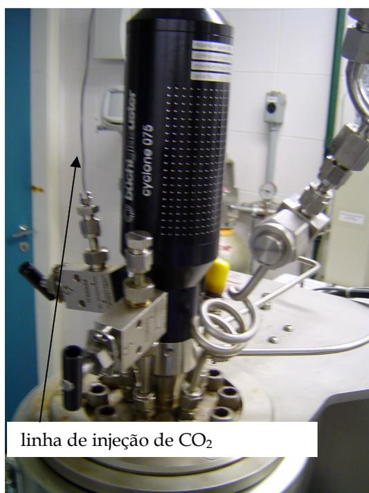
Figura 4.3.3.4. Linha de injeção de  $\text{CO}_2$  no reator de transesterificação de óleo de soja com mistura etanol+ $\text{CO}_2$ .
