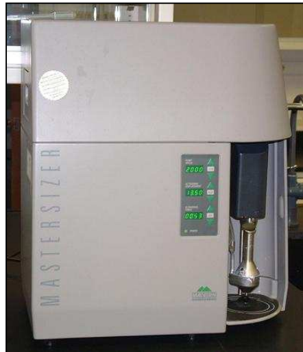
Figura 31 - Equipamento ( Malvern Mastersizer Micro Plus - MAF 5001 ) para caracterização da distribuição granulométrica da resina.
