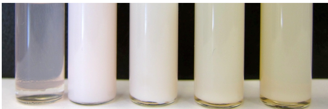
Figura 4.26 – Migração do agente RAFT (ácido 4-cianopentanóico ditiobenzóico) da fase dispersa (aquosa) para a fase contínua (orgânica) do sistema de pré-mistura da miniemulsão inversa. Teste realizado utilizando DMAEA como monômero e 0,01 g de agente RAFT. Frascos da esquerda para a direita: (1) antes da ultrassonificação, (2) após a ultrassonificação, (3) 60 minutos, (4) 240 minutos e (5) 20 horas de polimerização.
