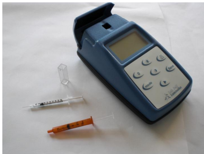
Figura III. 14: Kit LuminoTox®, composto do leitor, cubeta, seringa de cultura (âmbar) e seringa para inserção da organismo teste
