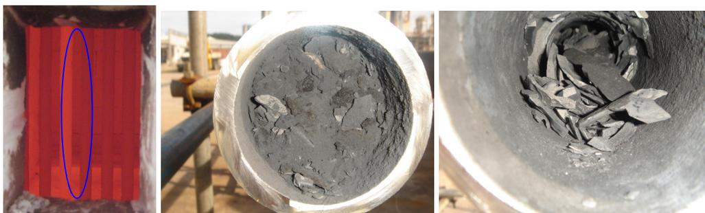
**Figura V.12: Serpentina incandescente, causada pela ausência de fluxo, e entupimento das serpentinas por acúmulo de coque.**
