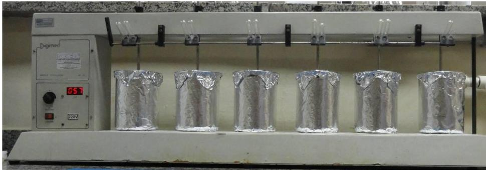
Figura IV. 2: Fotografia do equipamento de teste de jarro utilizado para os ensaios de Fenton.
