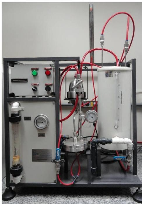
Figura IV. 12: Fotografia do Sistema de osmose inversa de escala de bancada
