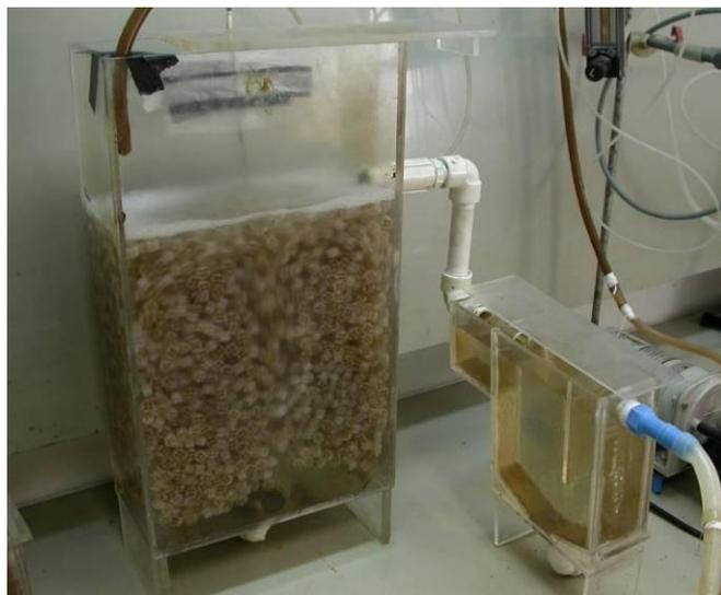
Figura IV. 6: Fotografia do reator operado de forma contínua  $MBBR_{cont}$ .
