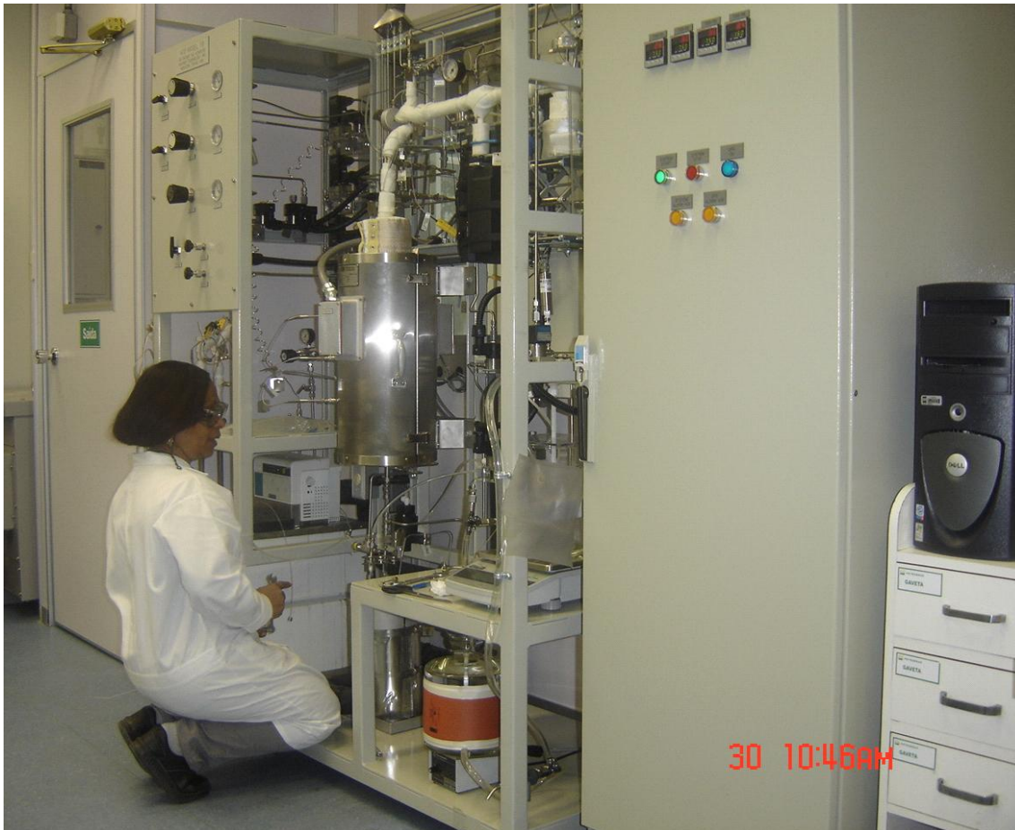
Figura 2.4 – Unidade de teste catalítico ACE – FB.
