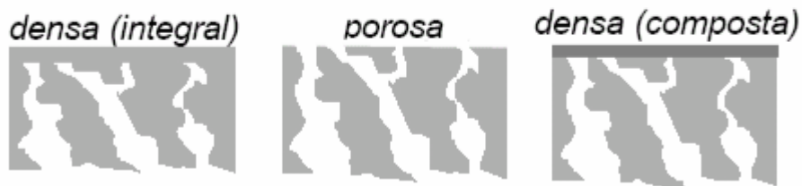
Figura 2.2– Representação esquemática das principais morfologias de membranas. (HABERT et al. , 2003)
