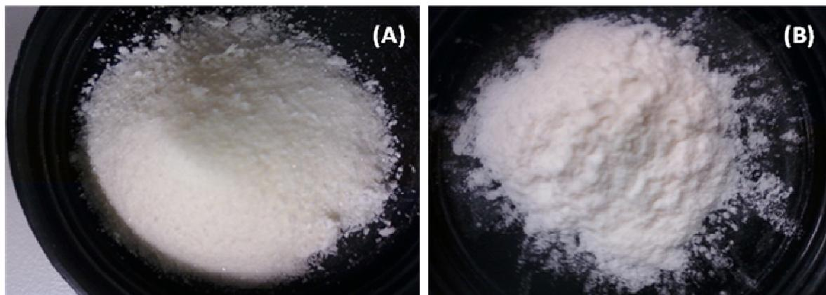
Figura 30 - (A) Amostra seca no liofilizador; (B) Amostra seca no spray dryer
