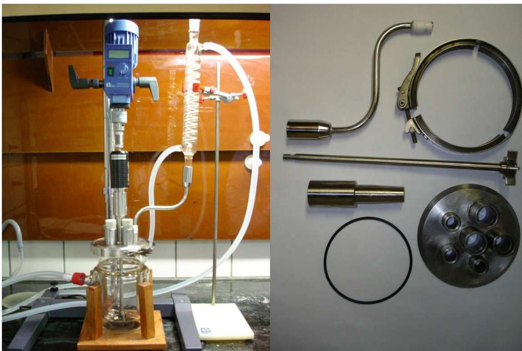
Figura 6 – Foto do reator e dos acessórios empregados na polimerização.
