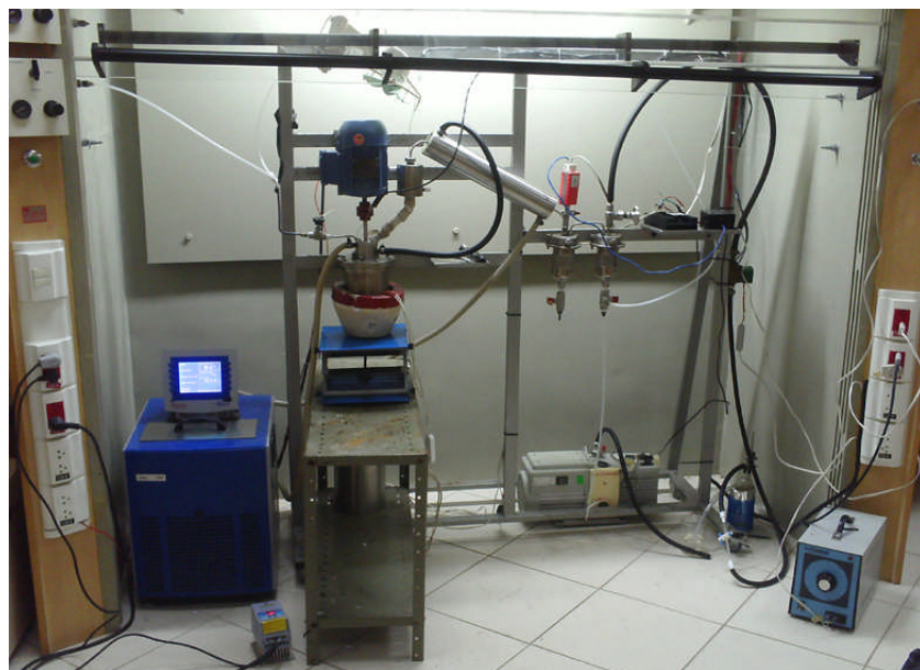
Figura 7.7: Unidade experimental para a polimerização in situ do PEPT.
