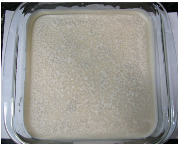
Figura 7.9: MMT-metil homogeneamente dispersa na mistura oligomérica obtida após polimerização incompleta.
