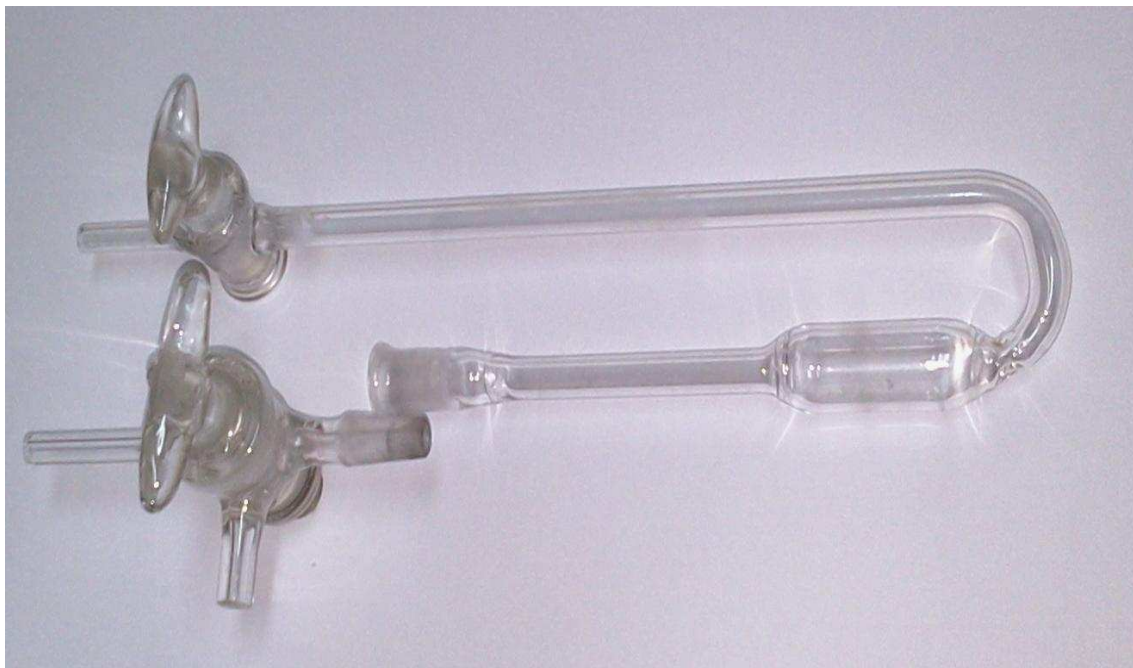
Figura 3.5 – Reator utilizado para a síntese do \beta\text{-Mo}_2\text{C}/\text{Al}_2\text{O}_3 empregado nas análises de DRIFTS.
