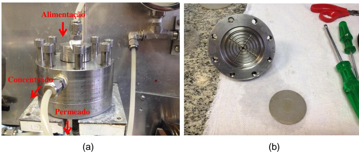
Figura 4.6(a) e (b): Célula em aço inox utilizada nos experimentos de osmose inversa.
