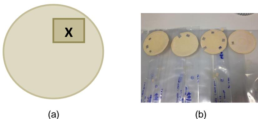
Figura 4.10: Esquema (a) e Foto (b) da região de amostragem da membrana.
