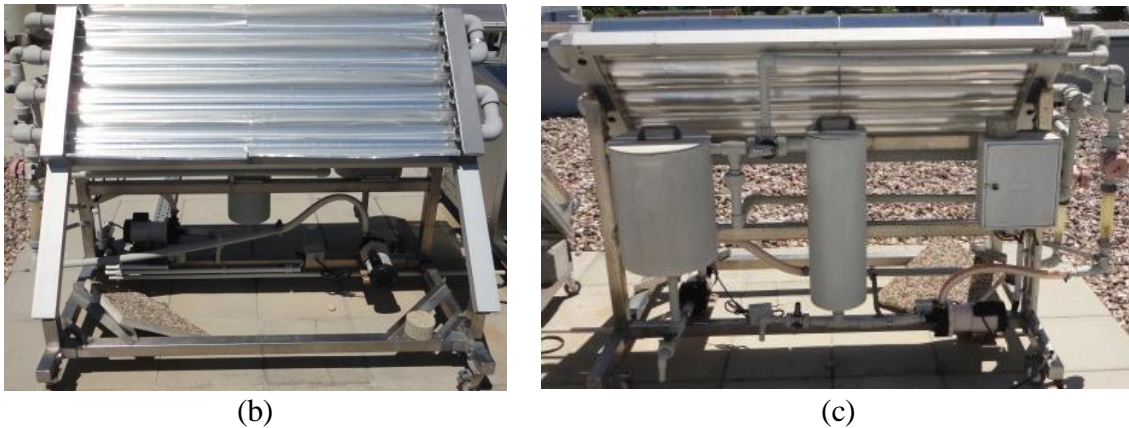
Figura 4.2. (a) Fluxograma do sistema da planta piloto: TM – Medidor de temperatura; pH – pHmetro; CPCs – Coletores parabólicos compostos; UV-R – Radiômetro UV; RT – Tanque de recirculação; CP – Bomba centrífuga; R – Rotâmetros; V1 e V2 – Válvulas de recirculação/descarga; V3, V4 – Válvulas de controle de vazão; V5 – Válvula modo CPCs; V6 – Válvulas de alimentação dos RTs; — Caminho principal; ---- Caminho alternativo; NRV – Válvula sem-retorno. Reimpresso (adaptado) com permissão de PEREIRA et al. [49]. Copyright © 2013, Springer-Verlag Berlin Heidelberg, Número da licença: 3219390117722; (b) visão frontal e (c) visão do sistema da planta piloto solar com CPCs.
