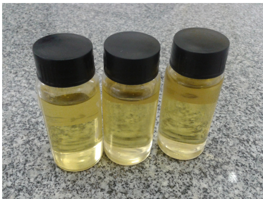
Figura 24 – Amostra de biodiesel de palma obtido através da etanólise enzimática a 42 °C.
