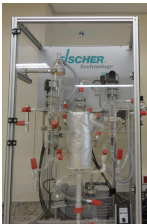
Figura 5 – Ebulliômetro Fischer. (1) câmara de mistura; (2) válvula de descarga; (3) resistência de aquecimento; (4) bomba Cottrel e câmara com jaqueta evacuada e espelhada; (5) sensor de medição da temperatura; (6) condensado; (7) bocal para amostragem da fase líquida; (7.1) frasco de amostra da fase líquida; (8) bocal para amostragem da fase vapor; (8.1) frasco de amostra da fase vapor; (9) e (10) solenóides; (11) válvula de equilíbrio; (12) válvula de ventilação. Figura adaptada de OLIVEIRA (2003).
