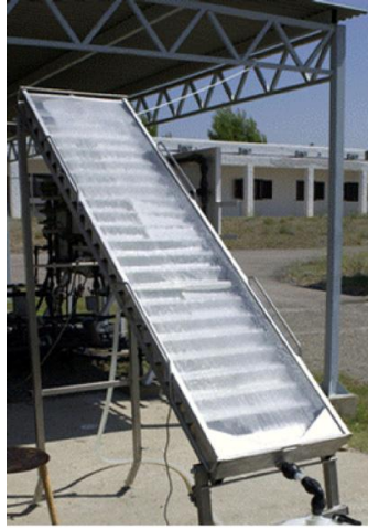
Figura 3.8 Coletor não concentrador tipo filme laminar localizado na plataforma de Almeria (GUILLARD et al. , 2003).
