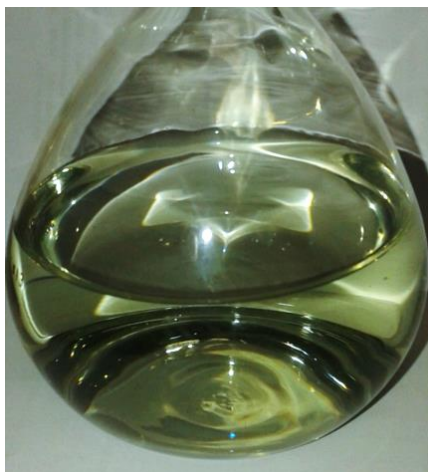
Figura 4.53 – Coloração da solução efluente ao reator após a reação de hidrogenação do ácido levulínico usando ácido fórmico como fonte de hidrogênio. Condições: 150 °C, 30 bar de N 2 , LHSV = 3h -1 , empregando uma solução aquosa equimolar de AF e AF (0,43 M) como carga.
