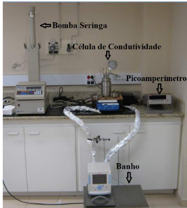
Figura 3.44: Aparato experimental para obtenção de condutividade elétrica de petróleo até altas temperaturas em célula pressurizada.
