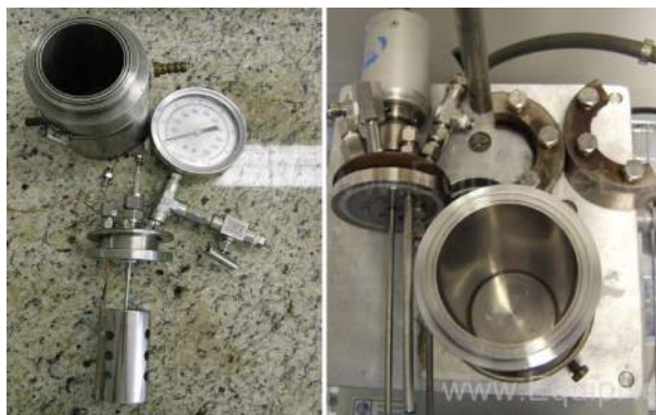
Figura 3.42: Modificação do reator de alta pressão para célula de condutividade. Direita, reator de alta pressão antes da modificação. Esquerda, célula de condutividade.
