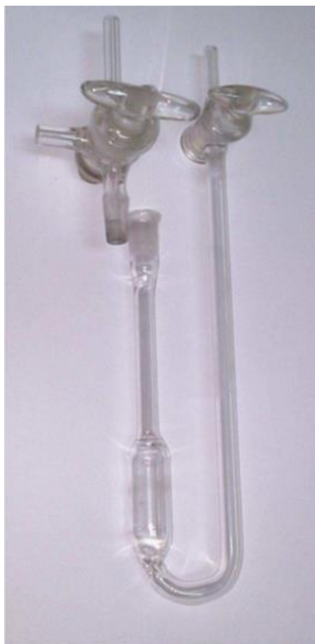
FIGURA 3.2: Reator utilizado para a síntese dos catalisadores empregados nos testes catalíticos.
