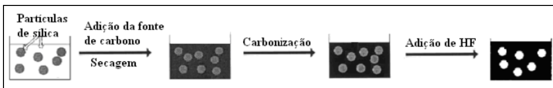
FIGURA 2.20: Esquema da síntese de carbonos porosos utilizada por SOUSA (2009b) (SOUSA, 2009b).
