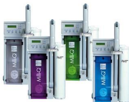
Figura 2.9 – Sistema Milli-Q fornecido pela MILLIPORE CORPORATION . Purificação de água com lâmpada UV para extermínio de bactérias.
