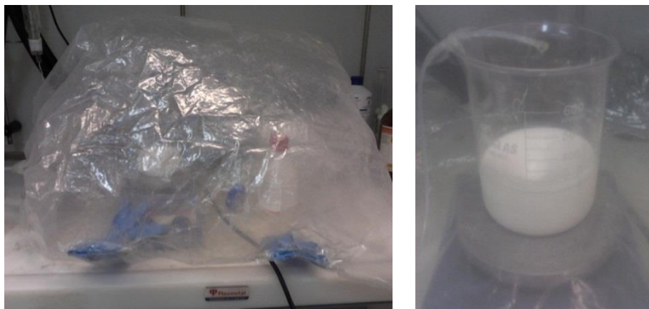
Figura 3.1 – Preparação do TiO 2 em atmosfera inerte pelo método de hidrólise lenta do isopropóxido de titânio.
