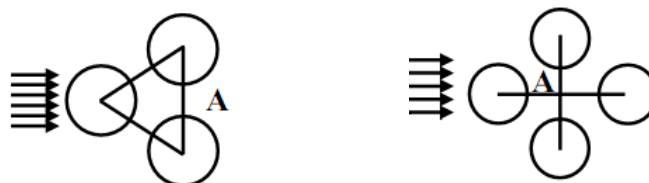
Figura 2.11 – Arranjos de partículas simulados por BEHJAT et al. (2008).
