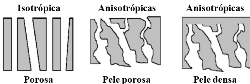
Figura 2.6. Morfologias características das membranas obtidas por inversão de fase. (Habert et al. 2006)
