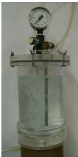
**Figura 3.7:** Coluna de borbulhamento de um processo convencional de ozonização.
