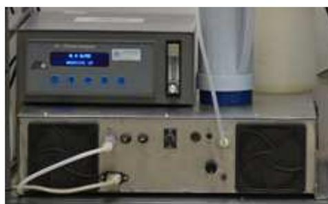
**Figura 3.2:** Sistema de geração e medição de  $\text{O}_3$  gasoso. Na parte inferior da imagem está o gerador e na parte superior o analisador de  $\text{O}_3$ .
