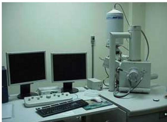
**Figura 3.4:** Equipamento de microscopia eletrônica de varredura (MEV).
