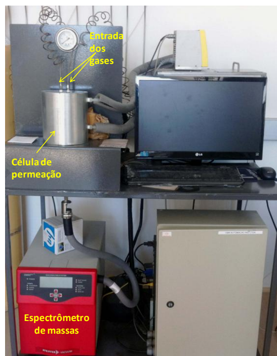
Figura 3.12. Aparato de permeação diferencial utilizado nos testes
