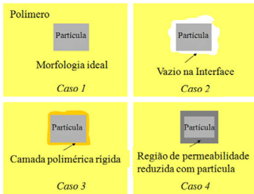
Figura 2.10 Diagrama esquemático da morfologia de interação entre polímero-partícula inorgânica. Adaptado de CHUNG et al. , 2007.
