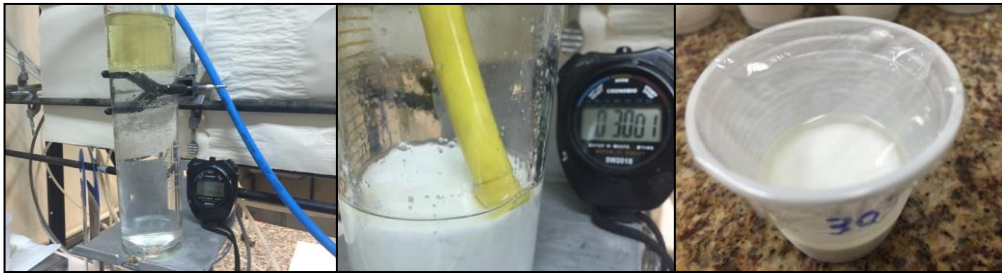
Figura 4. Fotos do início e fim do teste realizado para avaliar a influência do escoamento no teste de emulsificação.
