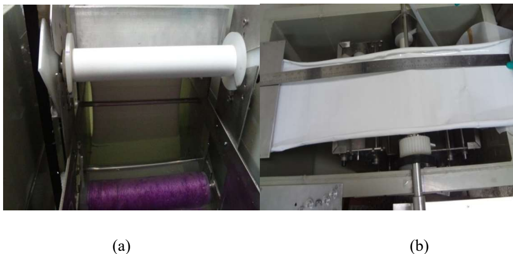
Figura 3-10 Processo de formação contínua de membrana, (a) Sistema em operação, vista anterior, (b) membrana Final.
