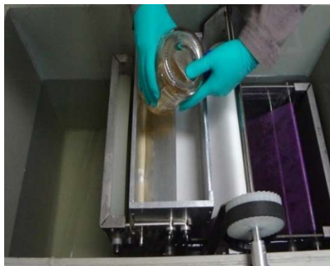
Figura 3-8. Carga de solução polimérica no compartimento da faca de espalhamento durante o início da operação
