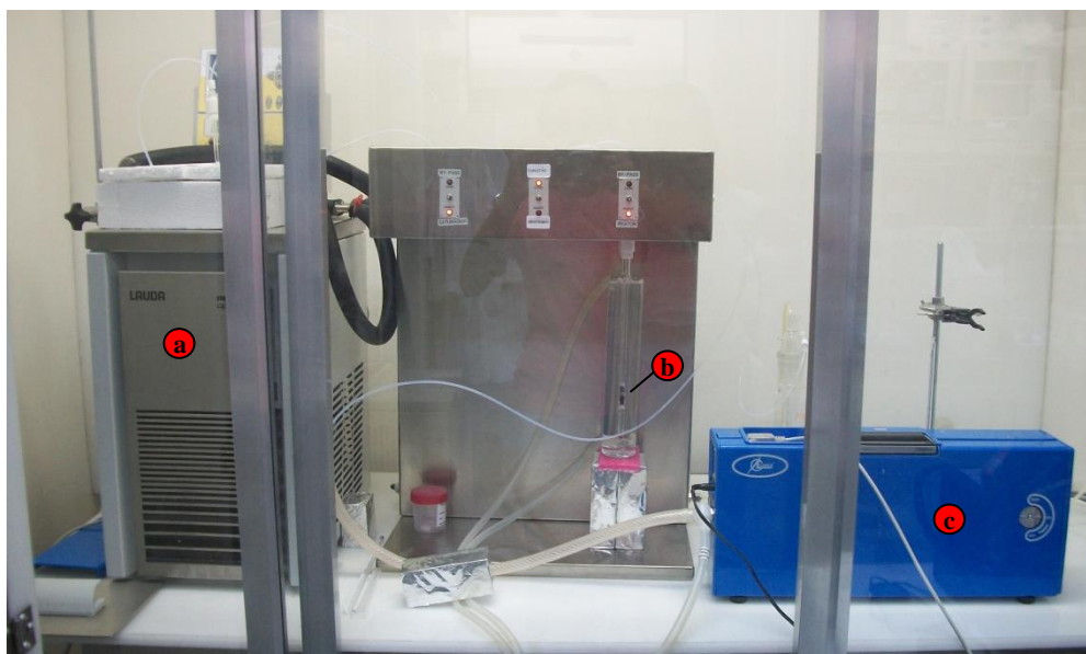
Figura 8. Sistema dinâmico de adsorção localizado no laboratório do GRIFIT. (a) Saturador de Hg^0 ; (b) Reator de leito fixo; e (c) Analisador de Hg (Lumex).
