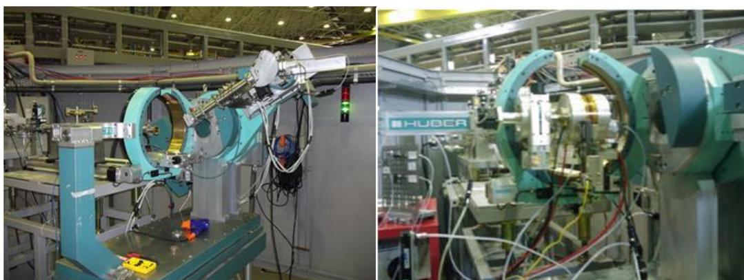
**Figura 6.4 – Goniômetro Huber da linha XPD do LNLS e forno Arara montado (foto da direita).**
