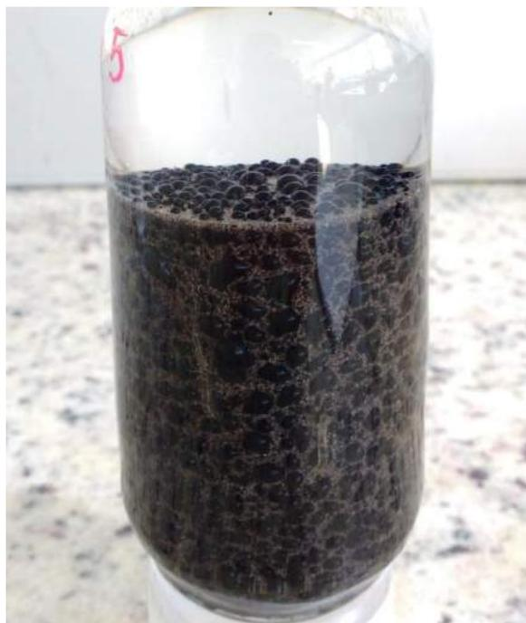
**Figura 3.73** – Gotas de óleo na superfície externa do afloramento de arenito Berea durante experimento de embebição espontânea na solução do permeado da membrana NF90.
