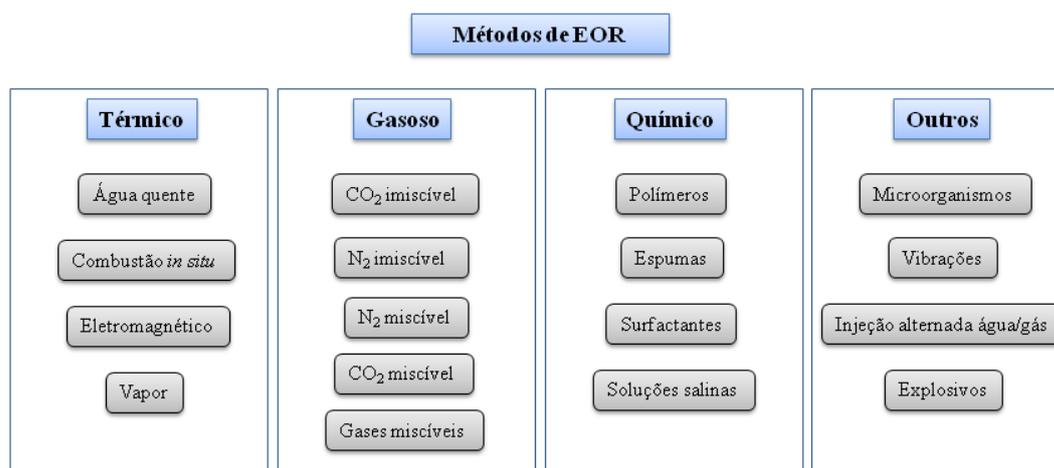
Figura 3.1 - Principais métodos de EOR. Fonte: baseado em OLAJIRE, 2014.
