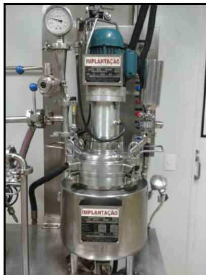
Figura 47. Unidade em escala piloto utilizada para a produção das partículas com morfologia casca-núcleo.
