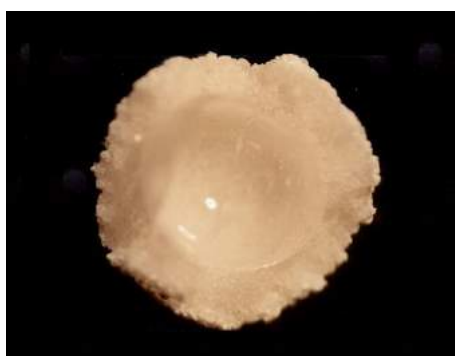
Figura 3. Partícula sintetizada a partir da técnica de polimerização simultânea em suspensão e emulsão ( Fonte LENZI et al., 2003 ).
