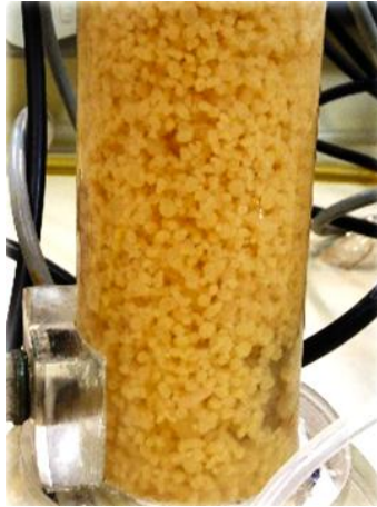
Figura 5.3: Grânulos formados dentro do reator após 40 dias de operação do reator.
