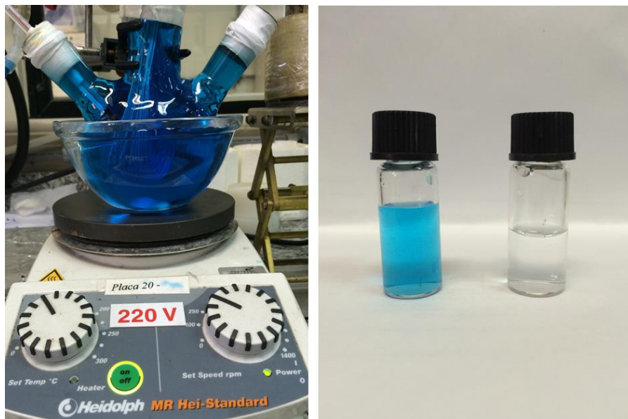
Figura 6.8: Fotografia do sistema de DM com solução etanol, água e corante azul (lado esquerdo) e frasco com a solução da alimentação azulada e permeado incolor (lado direito).
