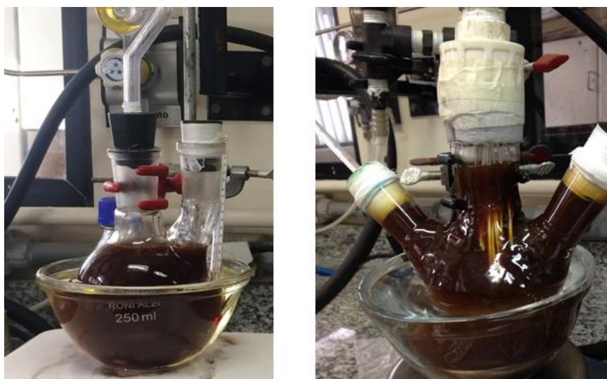
Figura 5.4: Fotografia dos experimentos em paralelo do experimento acoplado com a DM e o controle sem a membrana.
