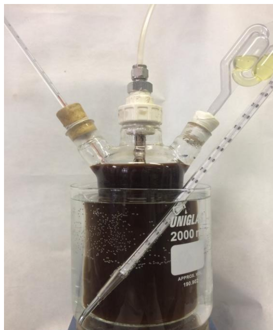
Figura 5.5: Fotografia do reator em operação o módulo de DM submerso inserido na entrada central do vaso.
