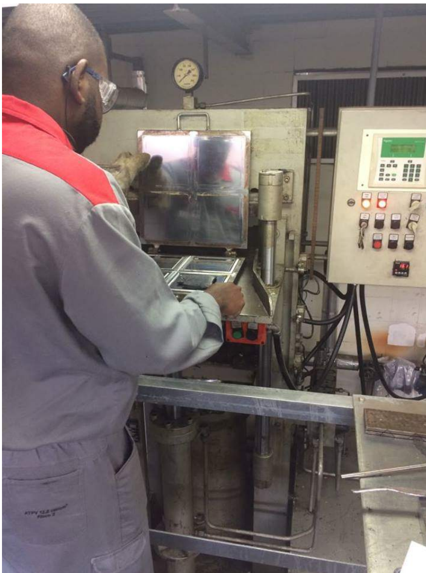
Figura 6.11: Equipamento utilizado para a vulcanização das borrachas.
