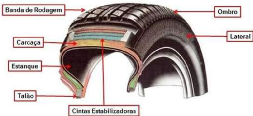
Figura 2.1: Esquema ilustrativo da estrutura de um pneu.
