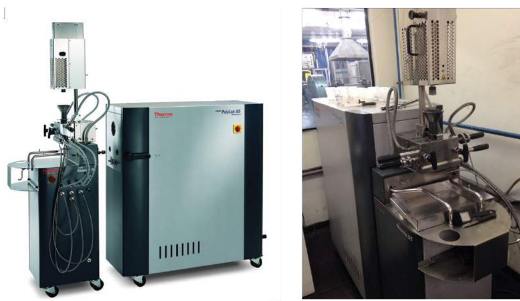
Figura 6.8: Misturador Haake utilizado para mistura dos componentes da borracha.
