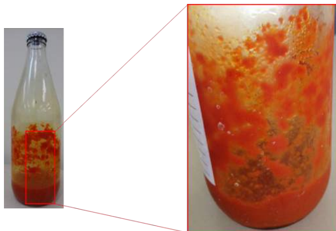
Figura 3.6: Iniciador sintetizado a 25 °C, 10 % em peso de solução DVB em ciclohexano, sem a presença de DTHFP e armazenado a -15 °C.
