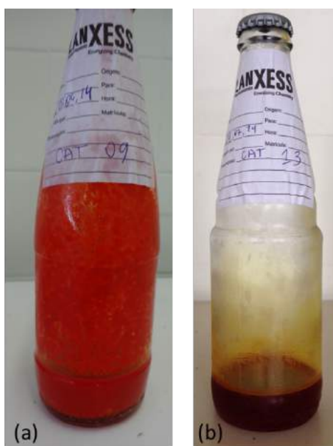
Figura 3.13: Iniciadores sintetizados a 25 °C, 5 % em peso de solução DVB em ciclohexano, razão molar DTHFP/n-BuLi de 0,1 e armazenados a -15 °C (a); 25 °C, 3 % em peso de solução DVB em ciclohexano, razão molar DTHFP/n-BuLi de 0,1 e armazenados a -15 °C (b).
