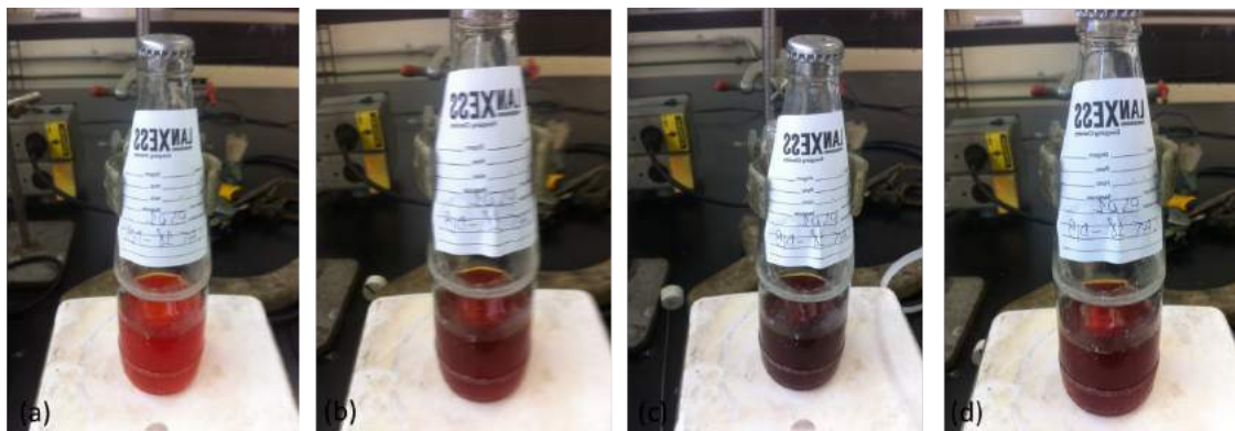
Figura 3.33: Aspecto final dos iniciadores produzidos utilizando DIB como agente de acoplamento: (a) poliestireno antes da adição do DIB; (b) poliestireno após 1 h de adição do DIB; (c) poliestireno após 3 h de adição do DIB; (d) poliestireno após 24 h de adição do DIB.
