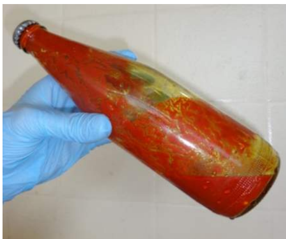
Figura 3.4: Iniciador sintetizado a 25 °C, 10 % em peso de solução DVB em ciclohexano, razão molar DTHFP/n-BuLi de 1,0 e armazenados a -15 °C.
