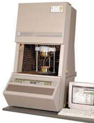
Figura 6.10: Equipamento utilizado para as análises de reometria.
