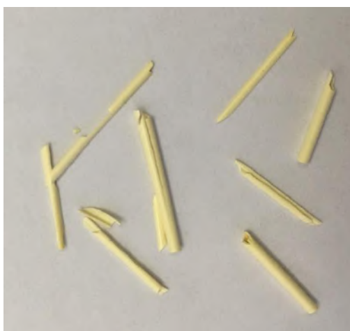
Figura 7.1. Fibras ocas quebradiças após modificação com a metodologia EDA_24.
