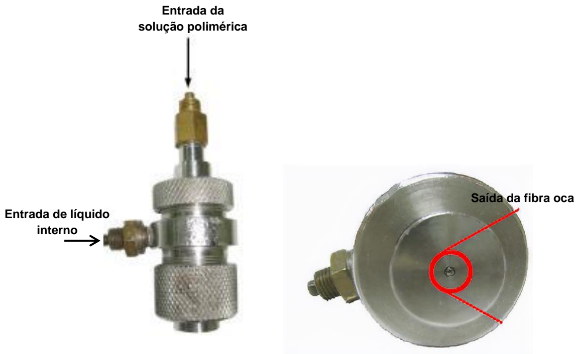
Figura 5.2. Detalhe da extrusora utilizada no sistema de fiação por extrusão da solução polimérica.
