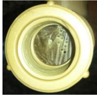
Figura 5.4. Módulo de permeação e detalhe da extremidade cortada para conexão da alimentação.
