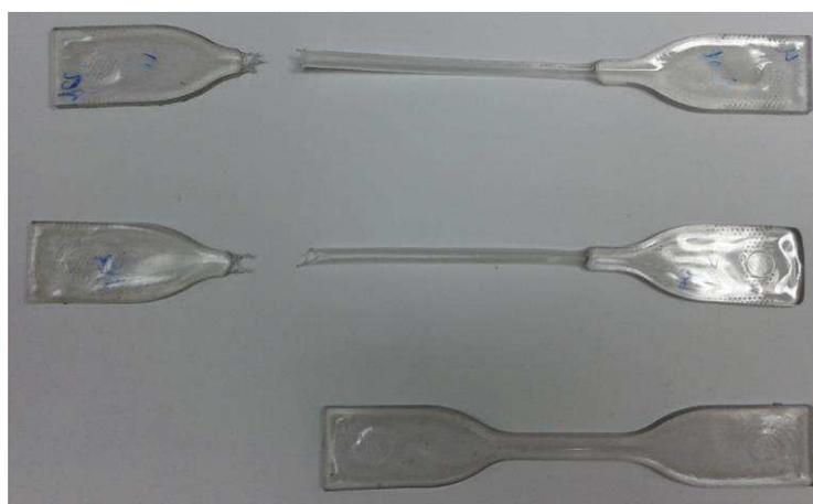
Figura 23. Exemplos de corpos de prova de poli(tereftalato de etileno) antes e após ensaios de tração.
