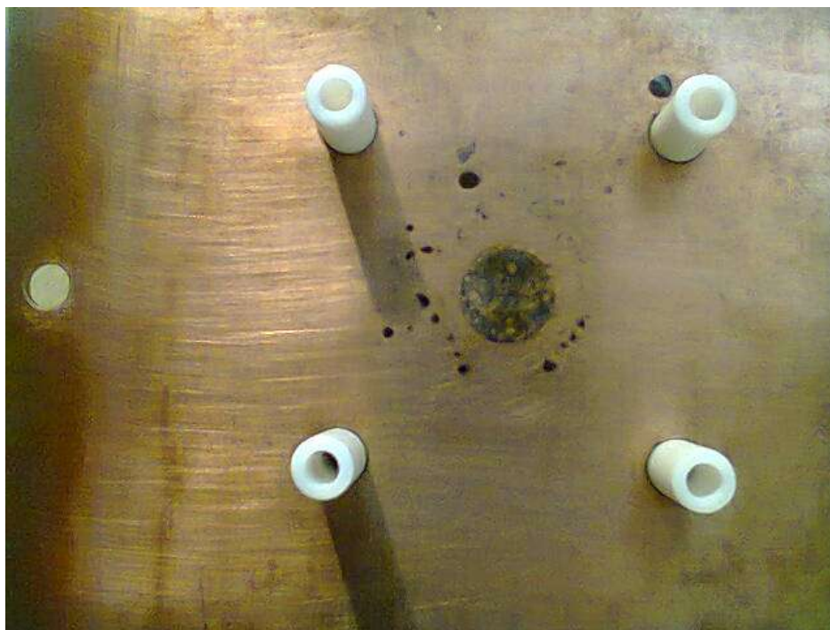
Figura 32: Foto do eletrodo de cobre desgastado após uma das análises de CEC feitas durante a dissertação de Mestrado. Nele podemos encontrar manchas pretas de óxido de cobre (II).
