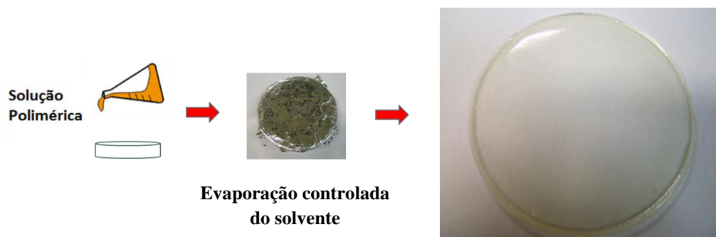
Figura A.2 – Metodologia de síntese por evaporação de solvente e membrana 12% m/m PU/THF homogênea obtida.
