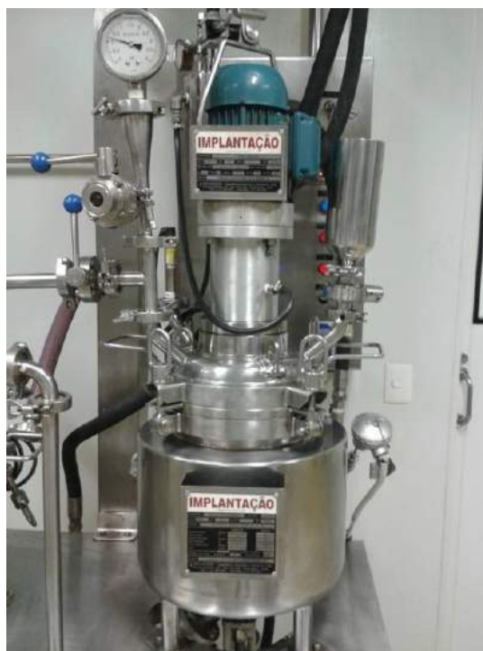
Figura 3.3: Unidade de polimerização referente ao sistema do reator de 12 L, presente na Planta Piloto.
