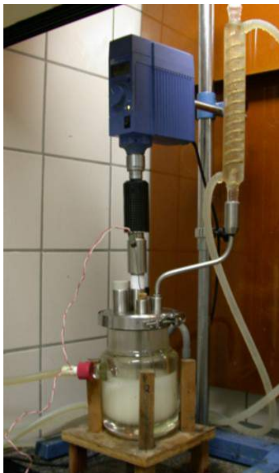
Figura 3.2: Unidade de polimerização referente ao sistema do reator de 1 L.
