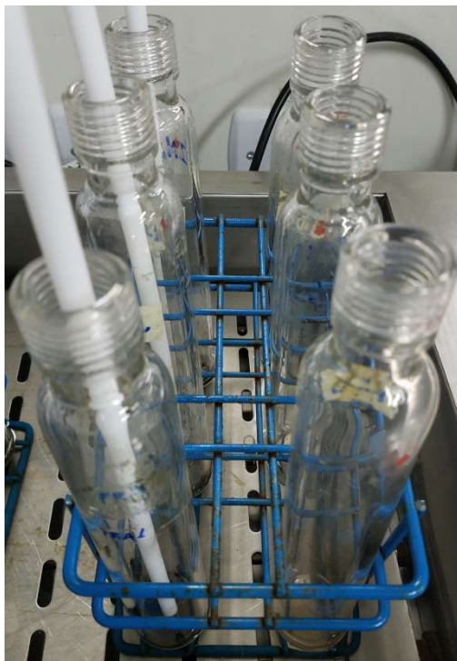
Figura 4.4. Foto ilustrativa dos tubos de pressão utilizados na etapa de determinação de lignina e açúcares (hidrólise ácida)
