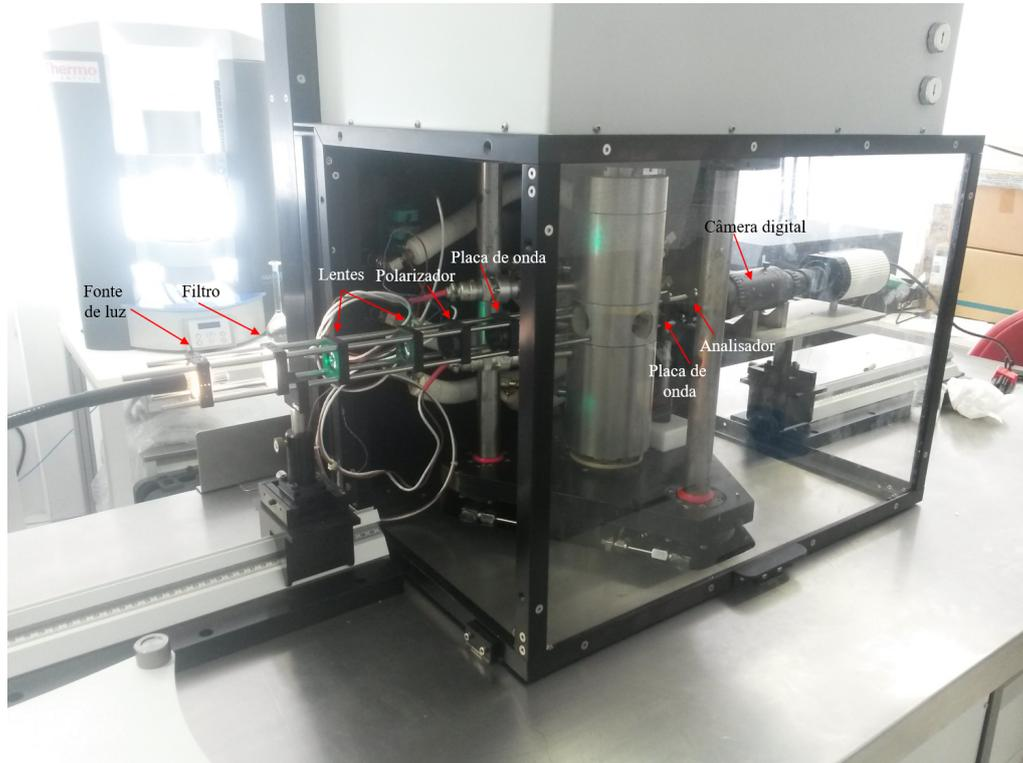
Figura 3.11: Módulo óptico para a obtenção das imagens de birrefringência induzida por escoamento acoplado ao MPR5S.
