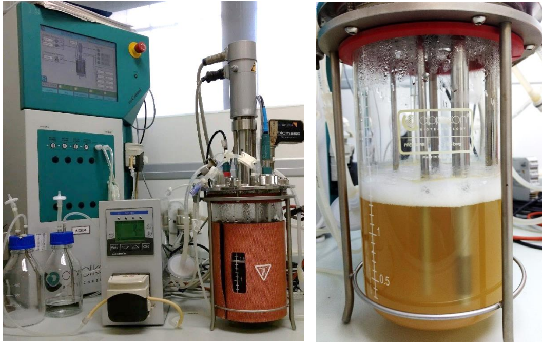
Figura 5.11 – Imagens do cultivo em biorreator de tanque agitado em batelada utilizando o biorreator Applikon ez-Control (esquerda). À direita, a foto mostra em maior detalhe a suspensão de células no interior do vaso do biorreator.
