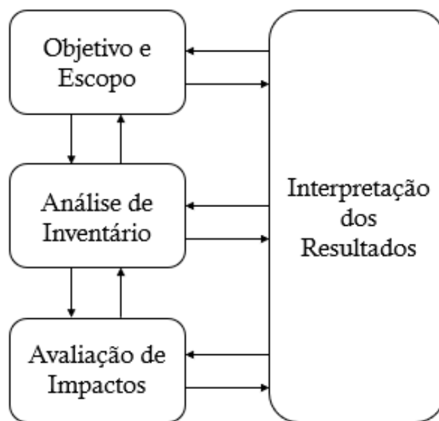
Figura 2-4: Estrutura usual de um ACV (adaptado de GOEDKOOOP et al. , 2016)
