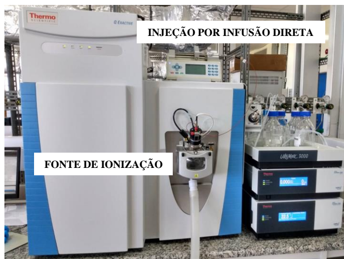
Figura 29 – Equipamento utilizado para quantificação de IMI. Espectrômetro de massas: ESI(±)-Orbitrap-HRMS. Laboratório de Espectrometria de Massas (LABEM-LADETEC-IQ-UFRJ).
