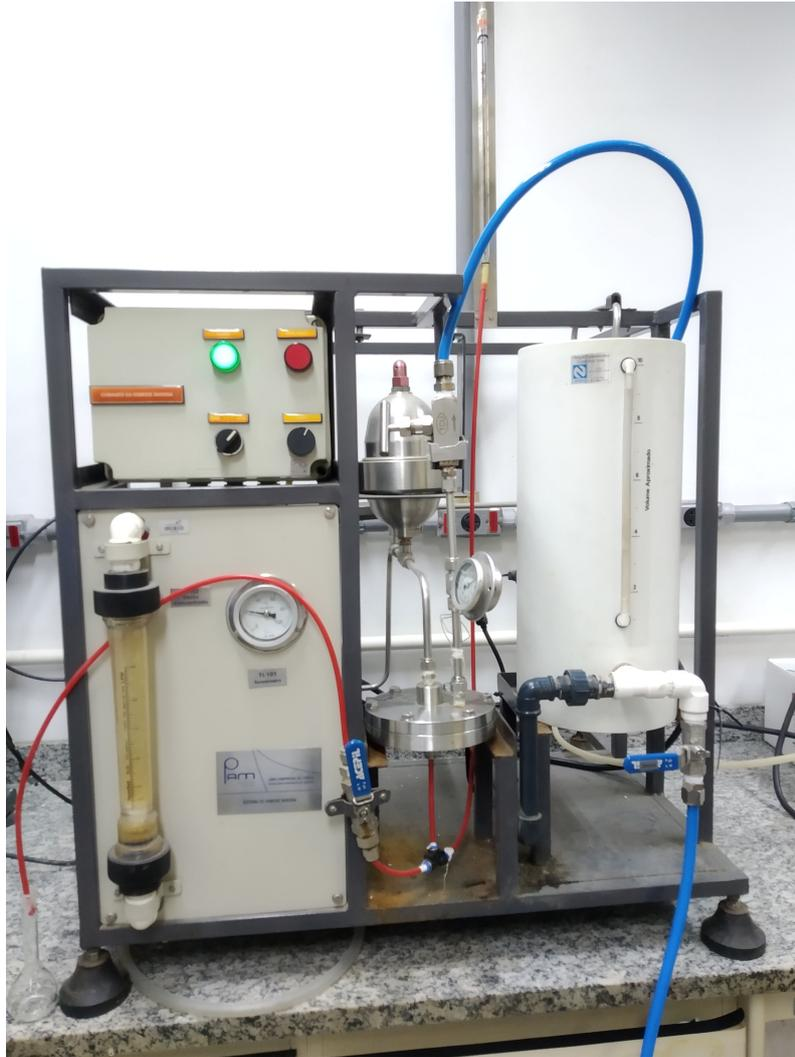
Sobre a permeação, esta é realizada em um compartimento específico do sistema de bancada, que é denominada a célula de permeação (PAM, 2010). A Figura 4.2 mostra o sistema de permeação, onde um recorte da membrana será utilizado de cada vez.
