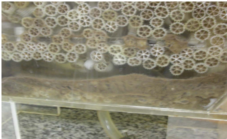
Figura 7. Fotos de um MBBR de bancada ilustrando a retenção dos suportes numa das paredes laterais do reator.
