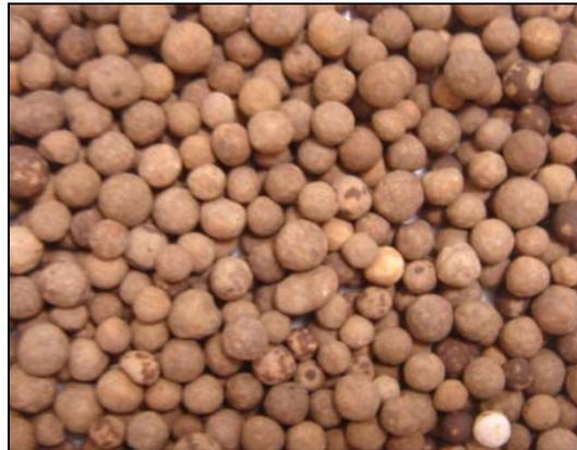
Figura 31: Catalisador comercial tipo Pd/Al<sub>2</sub>O<sub>3</sub>.
