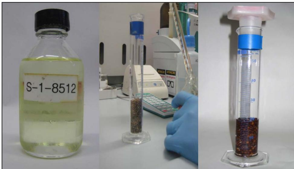
Figura 8: Teste de determinação da porosidade do leito catalítico.
