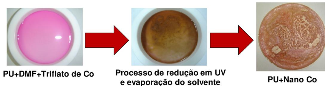
Figura A.4.4. Etapas de formação de membranas de PU incorporadas por nanopartículas de Co. Apresentando a solução de PU + DMF + Triflato de Co II, o processo de redução da nanopartícula dado pela radiação UV, por fim, a membrana de PU + Nanopartícula de Co 30%.
