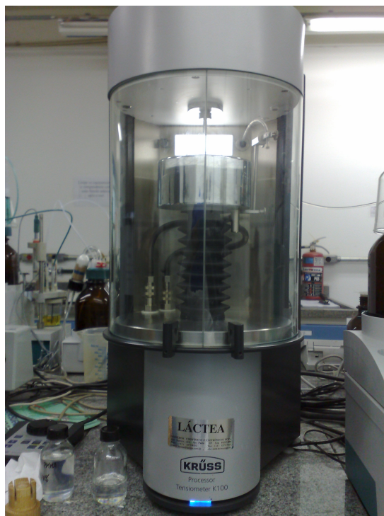
Figura 4.5: Fotografia do tensiometro K100 ( Krüß ) utilizado para as medidas de tensão interfacial.
