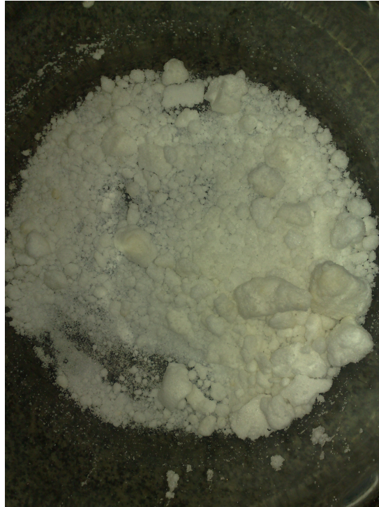
Figura 5.12: Aglomerados das partículas obtidas através da reação de polimerização contendo 10% de PVAc em estireno.
